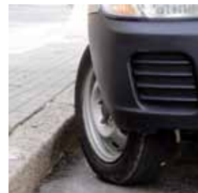
Disposición correcta de las ruedas al estacionar en repecho.
